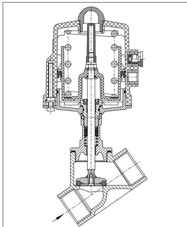
Bild 4: Schrägsitzventil Typ 3353;
