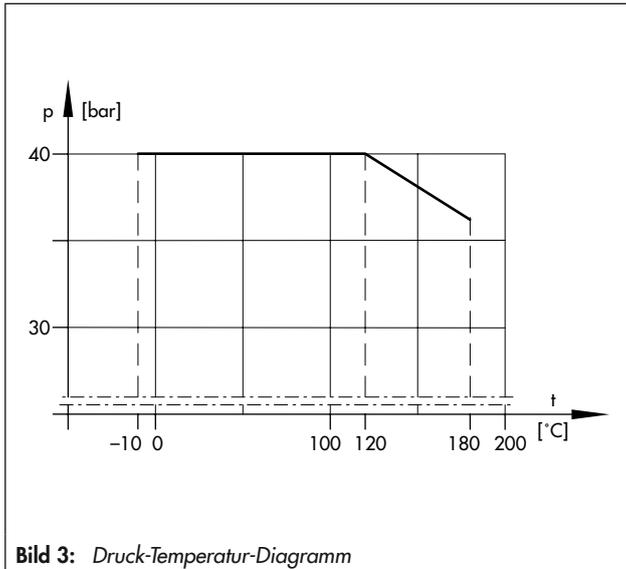
Bild 3: Druck-Temperatur-Diagramm
