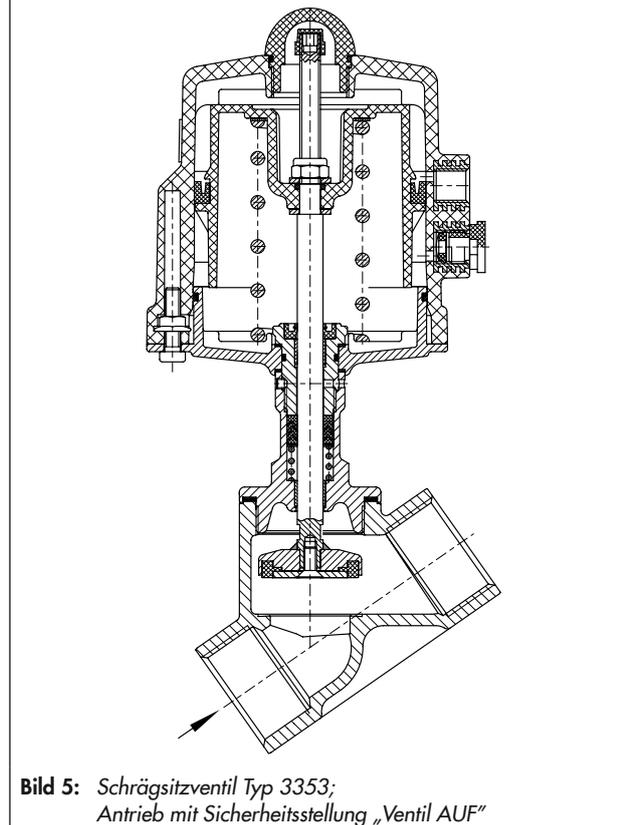
Bild 5: Schrägsitzventil Typ 3353;
