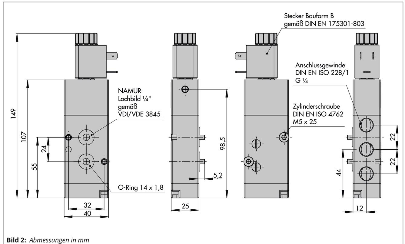
**Bild 2:** Abmessungen in mm
