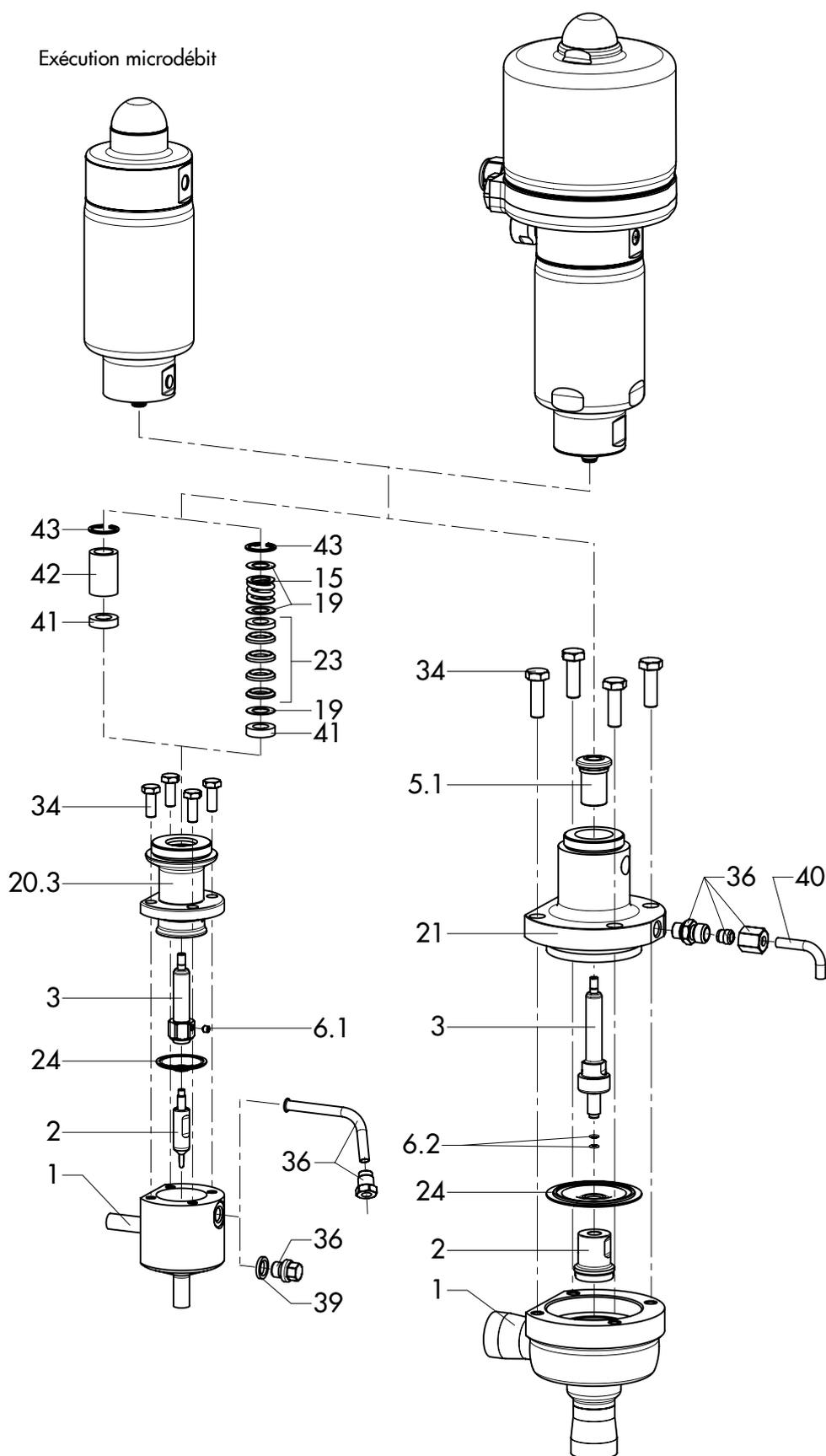
Vanne type 3349 avec servomoteur type 3271/3277
