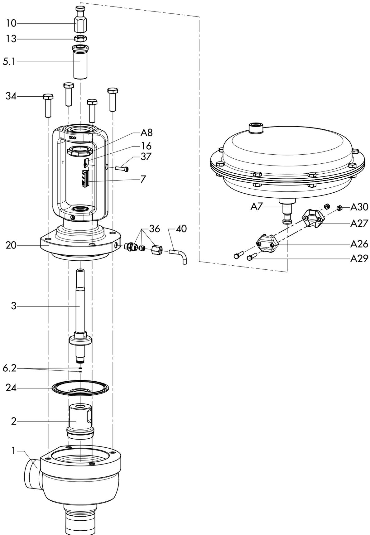
Vanne type 3349 avec servomoteur type 3271/3277
