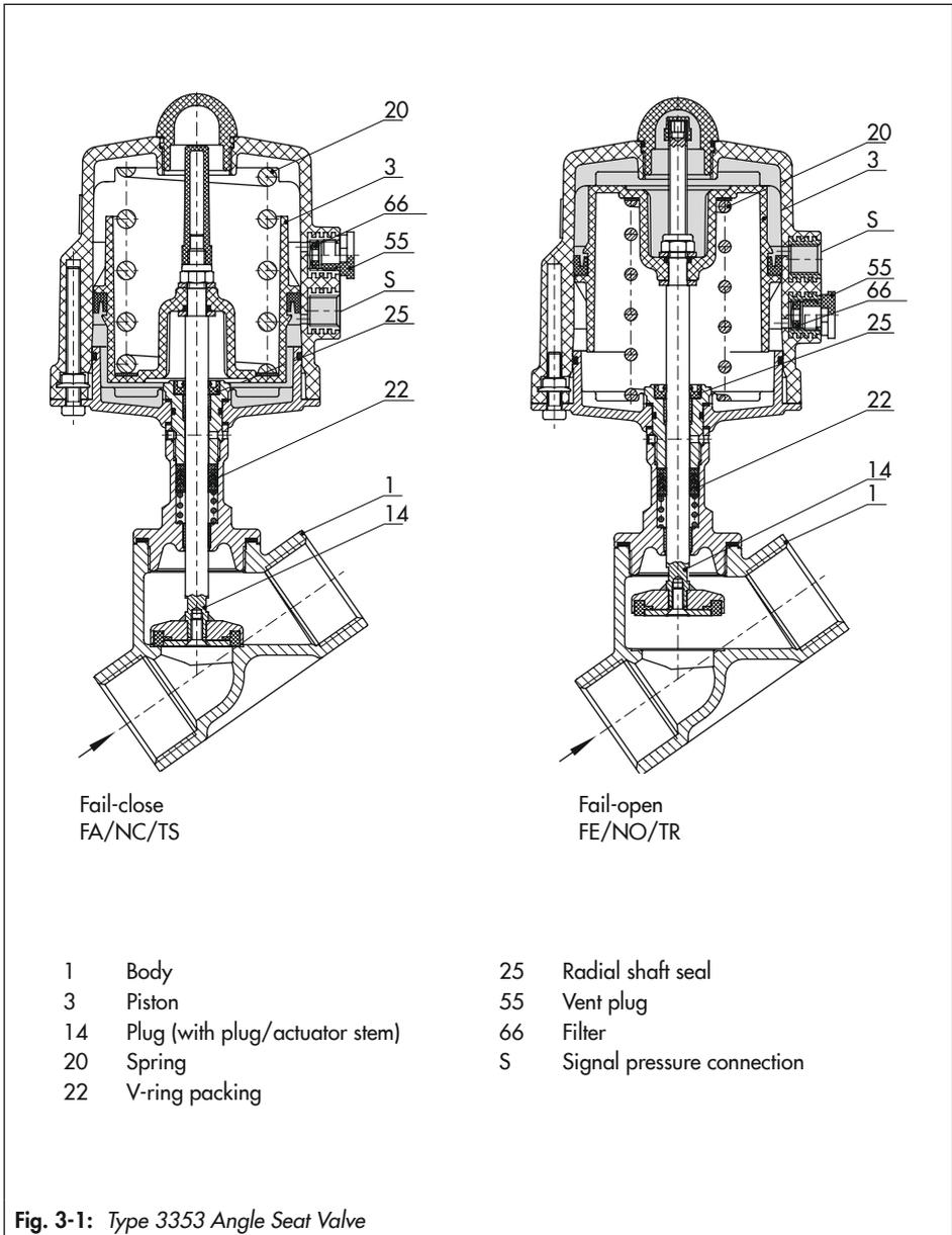
Fig. 3-1: Type 3353 Angle Seat Valve
