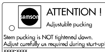
Afbeelding 3: Typeplaatje bij traceerbare klepsteelpakking
