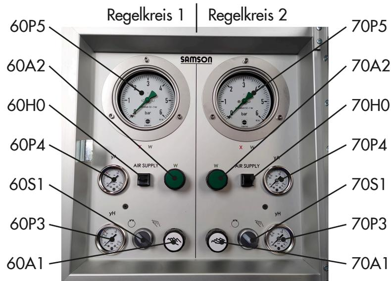
**Bild 10:** Pneumatischer Regelschrank Typ 7311-01/-02/-03 mit Anschlüssen
